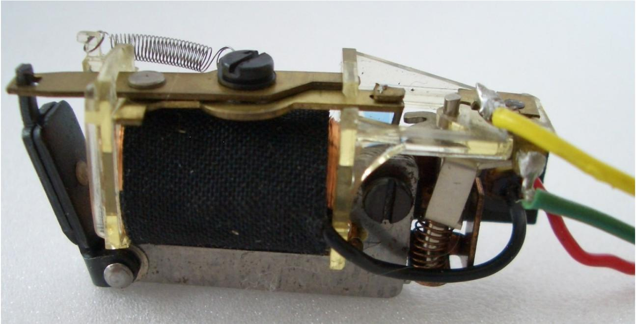
Spezielle Ausführung (21218) für die im Katalog angebotenen Bausätze 3921(V 200) und 3937(E 41 grün). Dem Relais 20824 wurde ein separater Lötstützpunkt aus schwarzer Presspappe hinzugefügt. Dieser Lötstützpunkt wurde mit der Befestigungsschraube zwischen Relais und Schraubbefestigung am Fahrgestell eingefügt. Die farbigen Kabel lagen jedem Bausatz bei.
